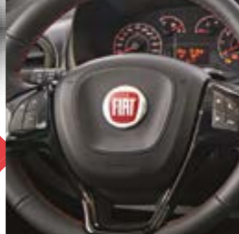
Teknolojisi sayesinde elleri direksiyondan çekmeden, Bluetooth ile cep telefonuna bağlanarak gelen çağrıları tek tuşla cevaplayabilme özelliğine sahip yeni fonksiyonel direksiyon.
